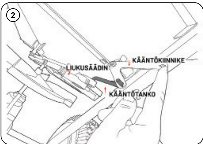
Empuje la parte superior del soporte pivote (21) de modo que el control deslizante (20 o 23) se empuje hacia atrás y la varilla pivot (22) se afloje.
