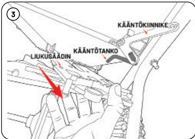
Rimuovi l'asta perno (22) spingendo la punta attraverso il foro nella parte superiore del cursore. Una volta rimossa l'asta perno, rimuovi il cursore (20 o 23).
